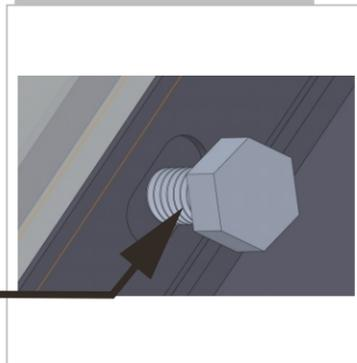
FIJACION DE POLICARBONATO POR MEDIO DE TORNILLOS CABEZA HEXAGONAL GALVANIZADOS DE 1/4"
