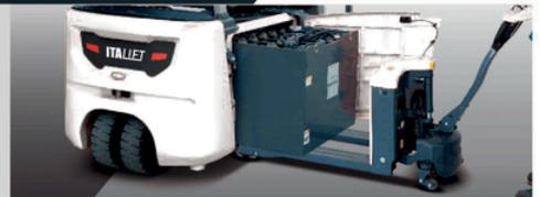
Tutti i componenti elettrici principali si trovano sul contrappeso per una manutenzione efficiente.
