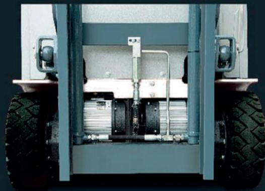
Prestazioni elevate, il carrello è dotato di unità di azionamento a doppio motore
