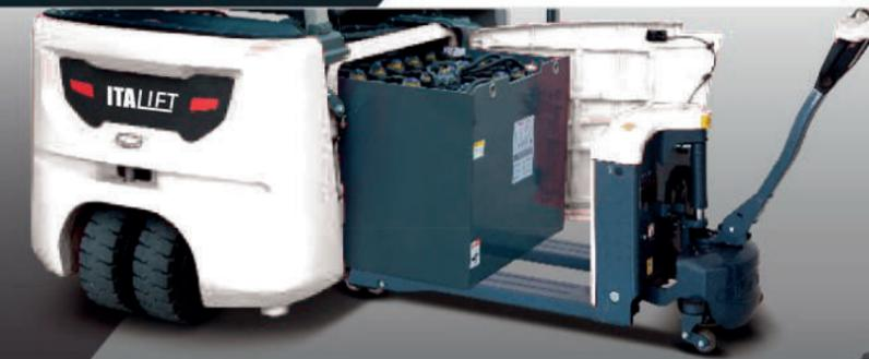
Tutti i componenti elettrici principali si trovano sul contrappeso per una manutenzione efficiente.
