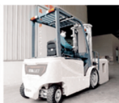
Test di conservazione a freddo Il carrello può funzionare ininterrottamente dopo 6 ore di funzionamento alternato nella cella frigorifera a -20°C e 12 ore di parcheggio nella cella frigorifera.
