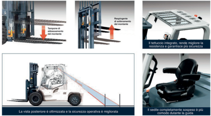
La vista posteriore è ottimizzata e la sicurezza operativa è migliorata. Il tettuccio integrato, rende migliore la resistenza e garantisce più sicurezza. Il sedile completamente sospeso è più comodo durante la guida.
