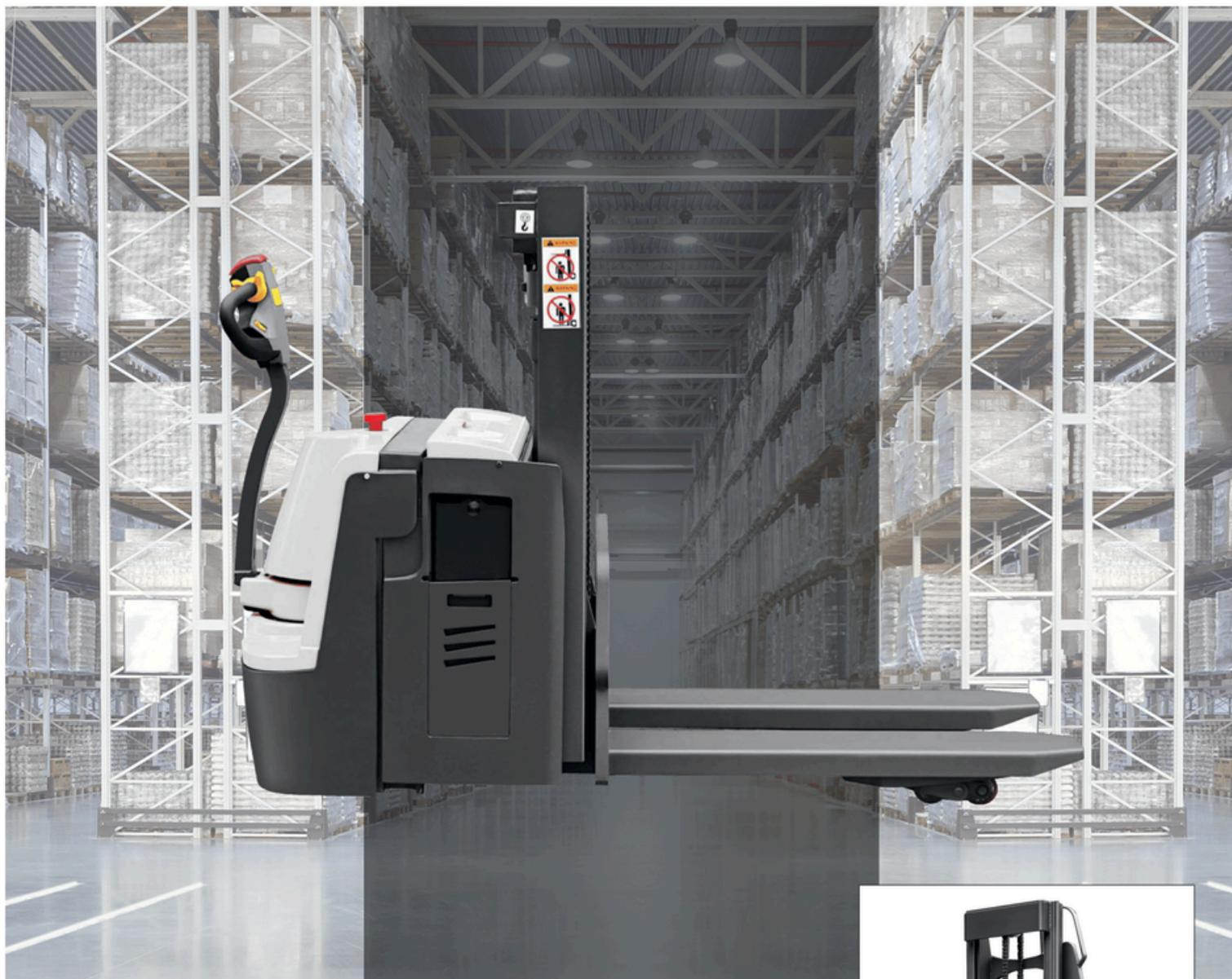
CBD20S ha un raggio di sterzata ridotto e un'altezza minima (1,08~1,38 m). Dotato di doppi pallet con un sollevamento iniziale di 120 mm. Può passare facilmente attraverso rampe e ponti e può trasportare carichi di 2.000 kg magazzini, piccoli supermercati, ecc.
