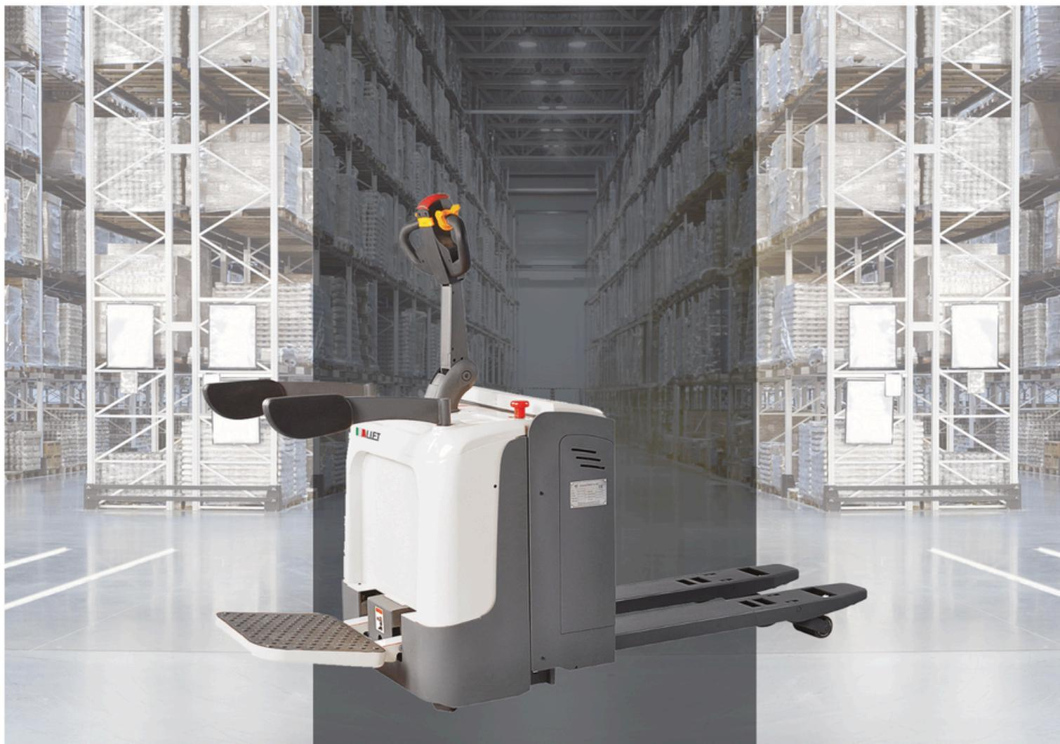
**CBD20R/25R è il transpallet con piattaforma di tipo stand-on, con raggio di sterzata ridotto e sistema di sterzo super leggero.**
