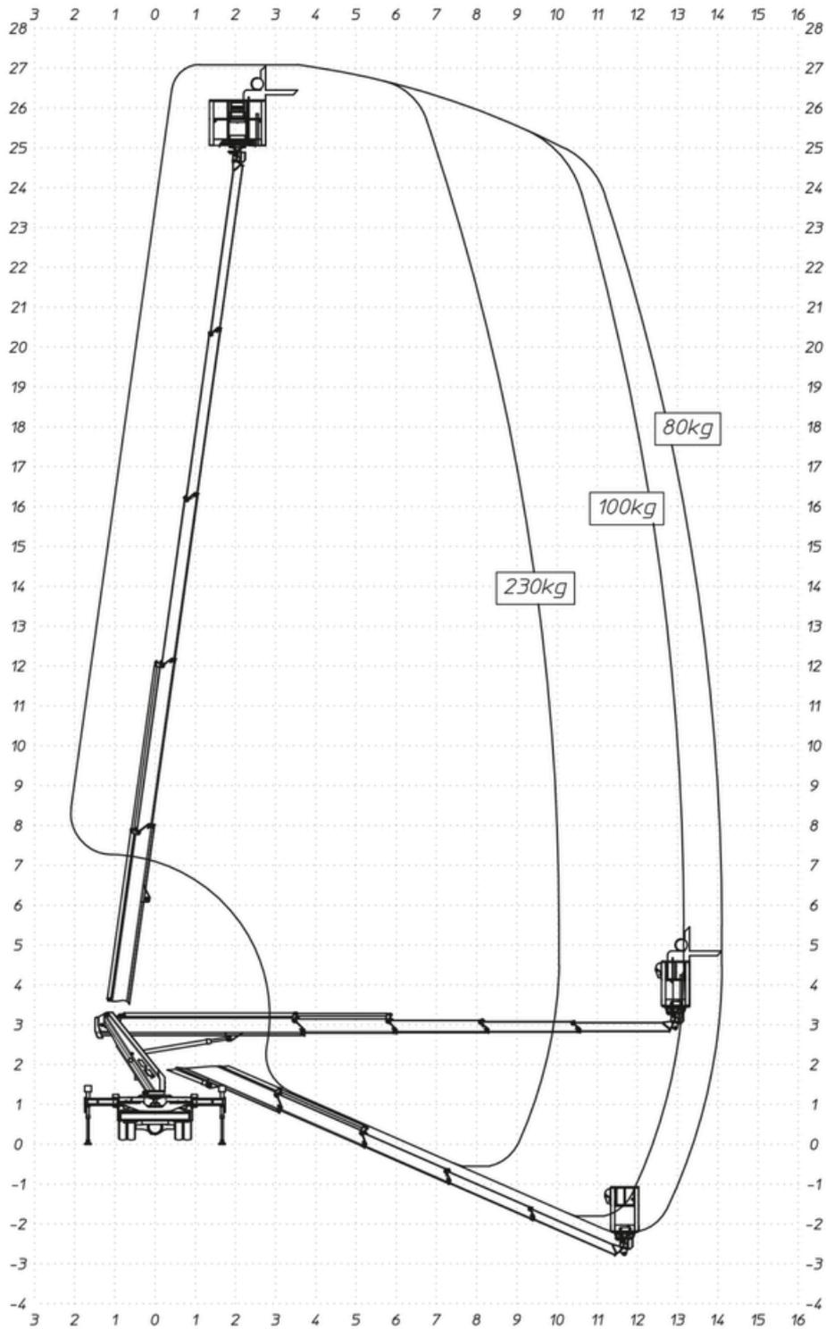
Macchina dotata di sistema di limitazione dello sbraccio a controllo di momento, le linee del grafico rappresentano le condizioni limite, ovvero con il carico massimo (carico nominale) e con il carico minimo (peso di una persona senza attrezzi - 80kg). Per ogni carico compreso tra questi due valori si ottiene una curva che sta fra le due linee tracciate.
