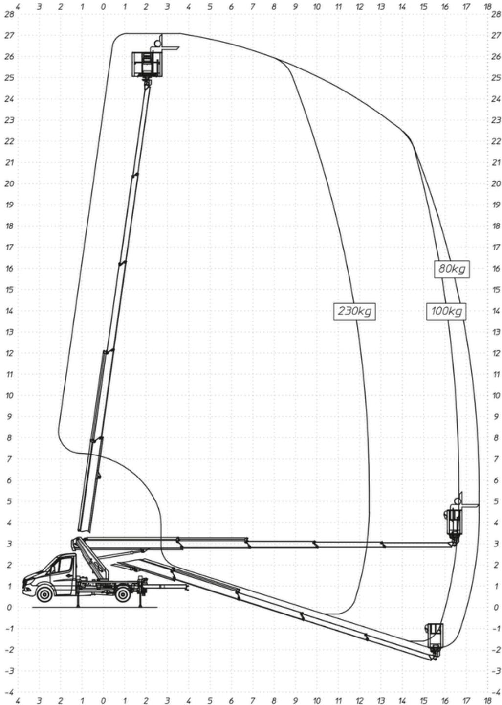
Macchina dotata di sistema di limitazione dello sbraaccio a controllo di momento, le linee del grafico rappresentano le condizioni limite, ovvero con il carico massimo (carico nominale) e con il carico minimo (peso di una persona senza attrezzi - 80kg). Per ogni carico compreso fra questi due valori si ottiene una curva che sta tra le due linee tracciate.
