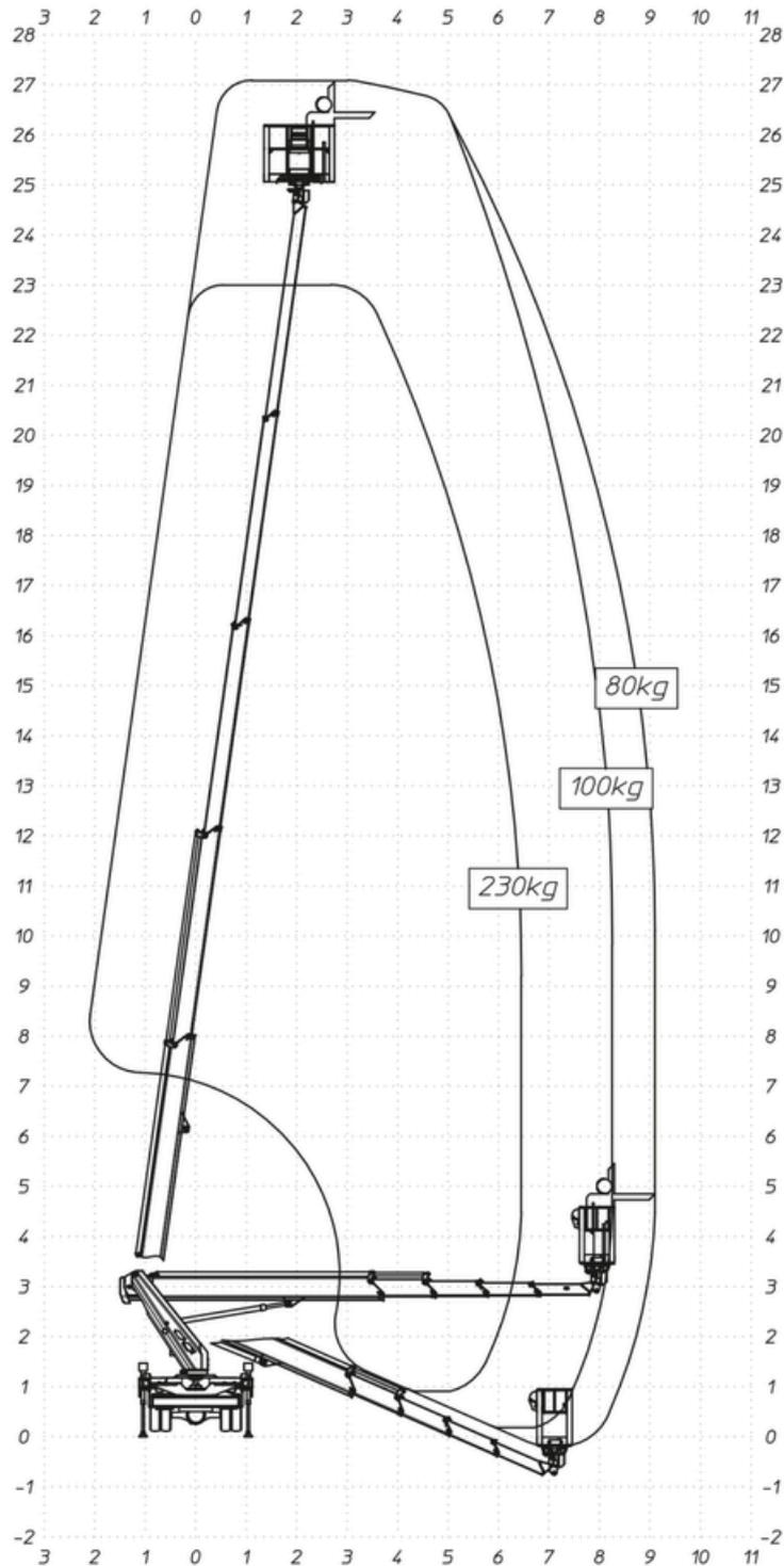
Macchina dotata di sistema di limitazione dello sbraccio a controllo di momento, le linee del grafico rappresentano le condizioni limite, ovvero con il carico massimo (carico nominale) e con il carico minimo (peso di una persona senza attrezzi - 80kg). Per ogni carico compreso tra questi due valori si ottiene una curva che sta tra le due linee tracciate.
