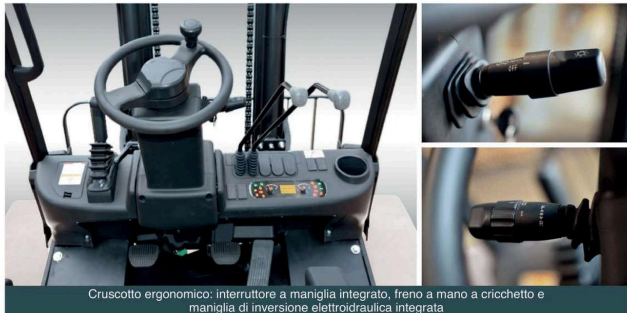
Cruscotto ergonomico: interruttore a maniglia integrato, freno a mano a cricchetto e maniglia di inversione elettroidraulica integrata
