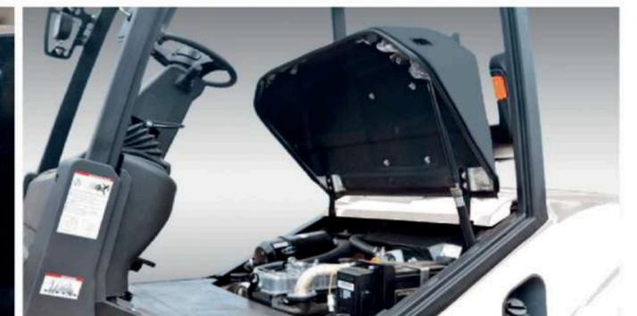
Copertura del motore con ampio angolo di lavoro,
