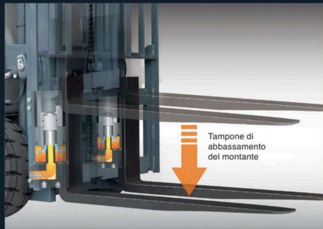
Tampone di abbassamento del montante
