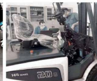
**Test di vibrazione del carrello**
