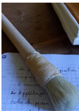
Pinceau d'apprêtage, surface polie blanc de Meudon et jaunissage
