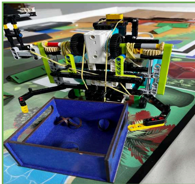
Foto 25 e 26: Melhorias na Garra do Robô R4.
