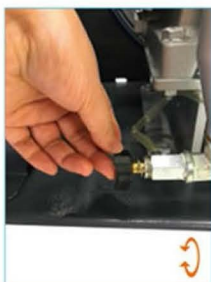
打开底端排放阀排出 污物后关闭
