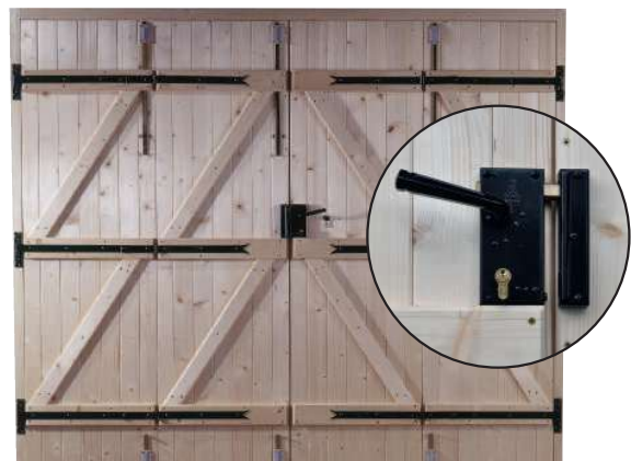
4 vantaux repliables Sapin du Nord : serrure 1 point, verrou baïonnette, bâti de 65 x 55 mm, avec bâti cintré dessous sans seuil
