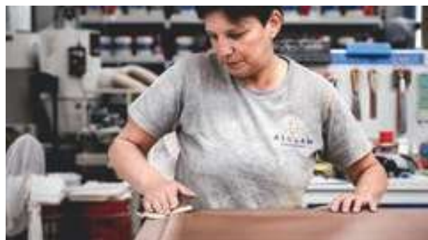
Chaque fenêtre est ensuite egrainée à la main pour une finition de haute qualité
