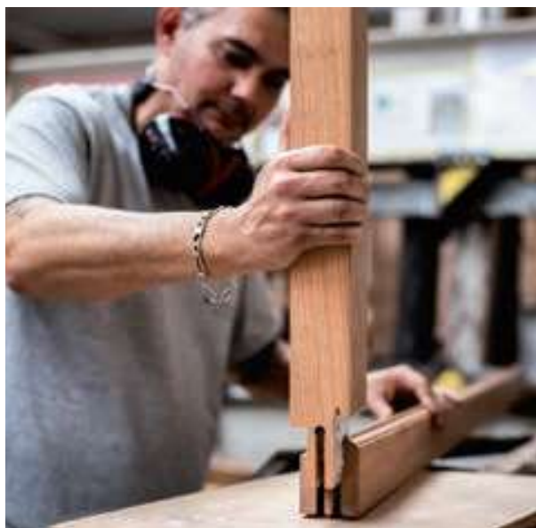
Assemblage traditionnel des ouvrants en double enfourchement
