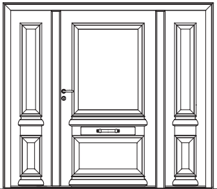
Odyssée avec semi-fixe (ouvrable) et fixe en faux ouvrant coordonné. H 2150 / L 2190.
