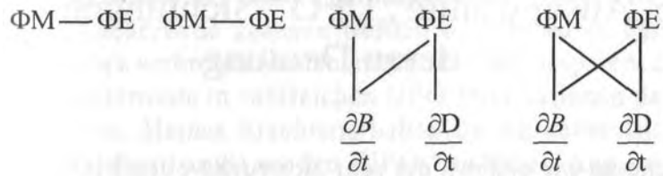
Abb. 5: Verkopplung zwischen Feldgrößen bei verschiedenen Feldtypen.
