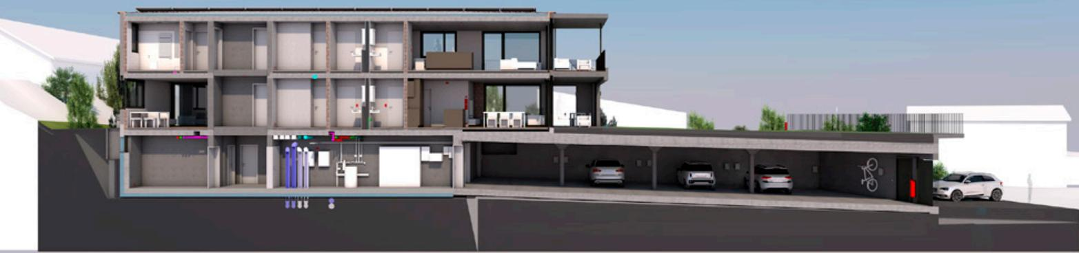
3D-Modell Längsschnitt Gebäude mit Tiefgarage (CAD/BIM-Software ALLPLAN)
