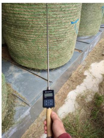
← L'utilisation d'une sonde d'humidité permet de contrôler l'humidité des bottes avant et pendant le séchage. Avec l'expérience, les utilisateurs savent en rentrant la tige de la sonde si le foin est sec ou non (source photo : EARL DE KERFORNAN)
