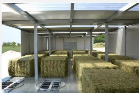
← Séchoir simple flux de bottes rondes ou rectangulaires (source photo : AGRICOMPACT)
