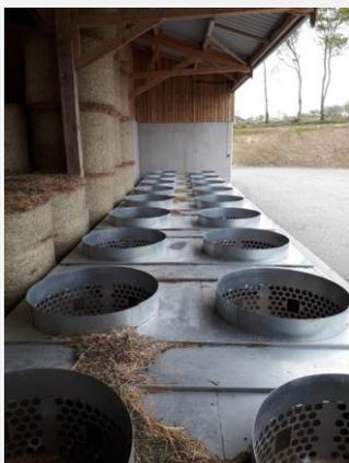
Séchoir simple flux 2 x 20 bottes rondes équipé de modules de séchage situés sous un appentis (source photo : SEGRAFO)
