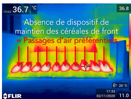
Visualisation à la caméra thermique des passages d'air préférentiels d'une cellule de maïs grain en court de séchage.
