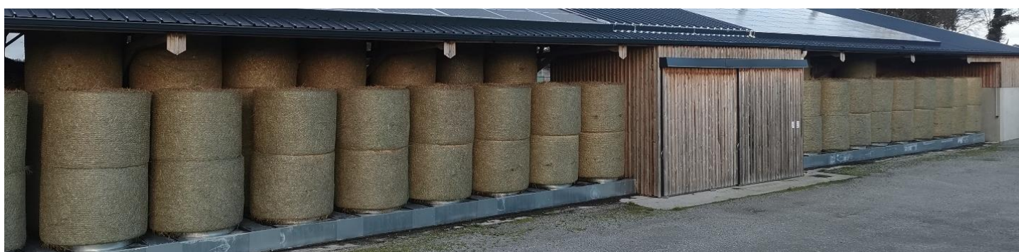
Les 40 bottes de la rangée inférieure sont en cours de séchage. Les 40 bottes supérieures sont ventilées dans l'attente d'être séchées (source photo : EARL DE KERFORNAN)
