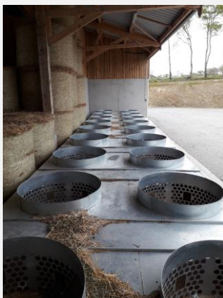
Séchoir simple flux 2 x 20 bottes rondes équipé de modules de séchage situé sous un appentis (source photo : SEGRAFO)
