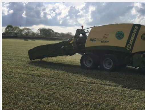
Presse à bottes cubiques équipée d'une chambre de pré compression à déclenchement et d'un système de pesé (source photo : ZEKA)
