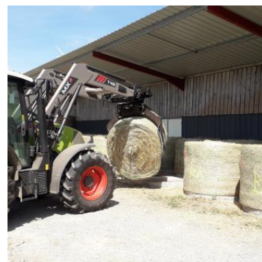
Retournement des bottes à l'aide d'une pince pivotante (source photo : SEGRAFO)
