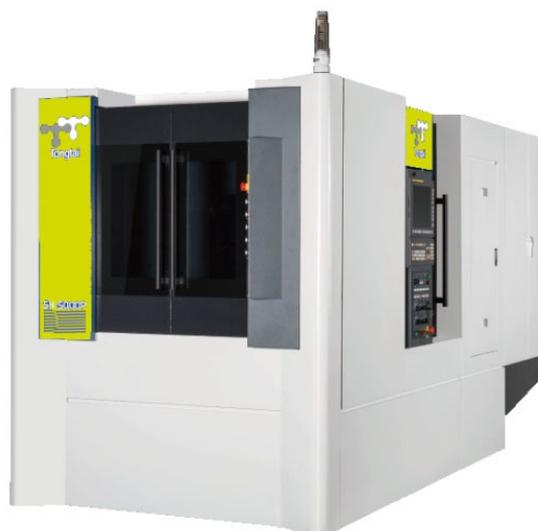
Le centre d'usinage horizontal 4 axes TONGTAI série SH est une machine conçue pour l'usinage de matériaux légers tels que l'aluminium ou la fonte. Elle est dotée d'un palettiseur 2 palettes pour le chargement d'une pièce en manuel ou automatique pendant l'usinage d'une autre pièce. La série SH est une machine rapide et propose des déplacements rapides jusqu'à 60m/min, et un changeur d'outils entraîné par came à rouleaux afin de réduire les temps de cycles.
