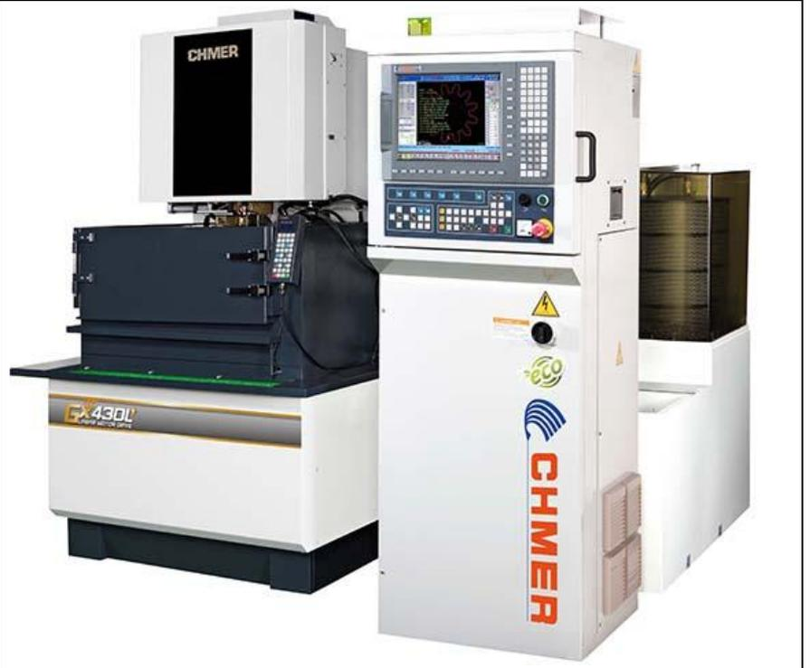
La gamme d'électroérosion fil à immersion de la série GX+ a été développée pour obtenir de grande précision. Dans les meilleures conditions d'installation et d'utilisation, après 5 ans d'utilisation la précision est et reste de +/- 3 $\mu$  (le positionnement est garanti 10 ans). La série GX+ est utilisée dans les industries : Aéronautique, automobile, médicales, moules et outils de coupe.
