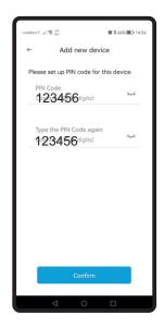
Assim que o módulo for emparelhado irá pedir para colocar um pin code de segurança de acesso às defenições do mesmo. Coloque um pincode de 6 dígitos.
