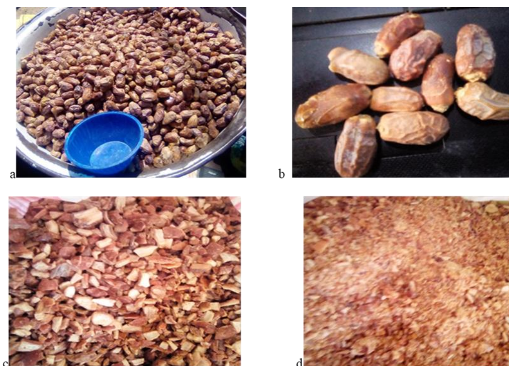
Figure II.1: Datte bournow à l'état brut (a,b); Datte bournow broyées à différentes granulométries (c,d).
