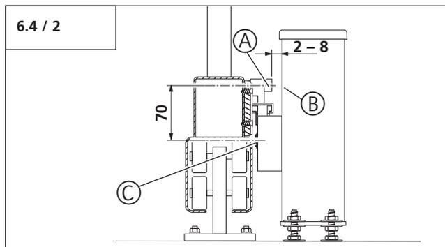
Монтаж магнита референтной точки зависит от примененной зубчатой рейки.
