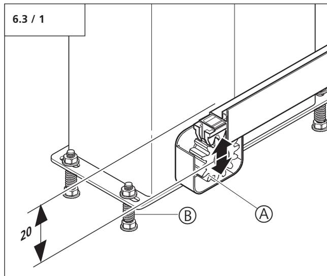
Высота цилиндрического зубчатого колеса (A) на электроприводе может быть установлена в диапазоне 20 мм.
