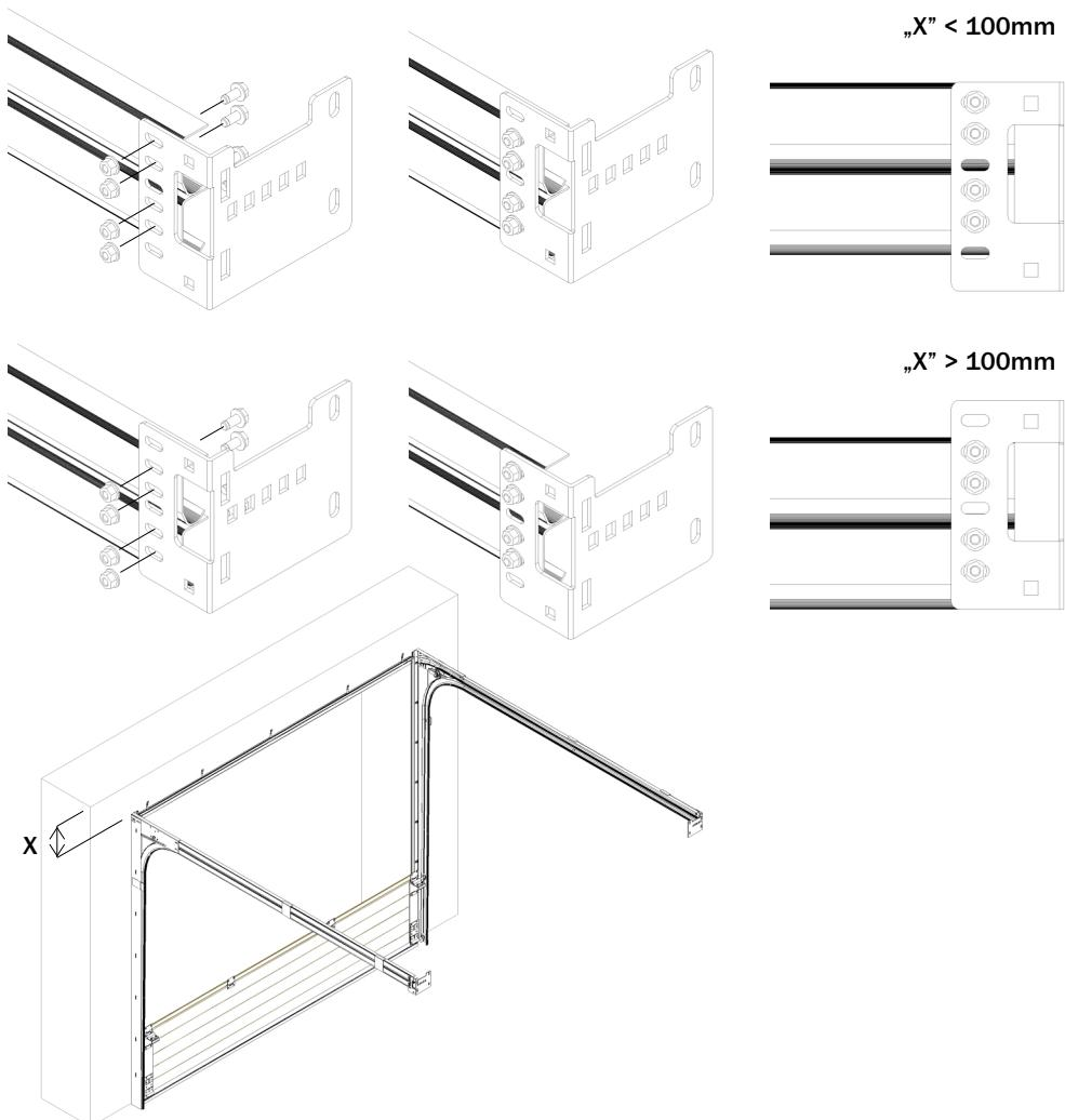
CZ Pomocí C-profilu spojíme horizontální kolejnice. C-profil přišroubujeme pomocí šroubů M8. C-profil nesmí vycházet z horizontálních kolejnic.
