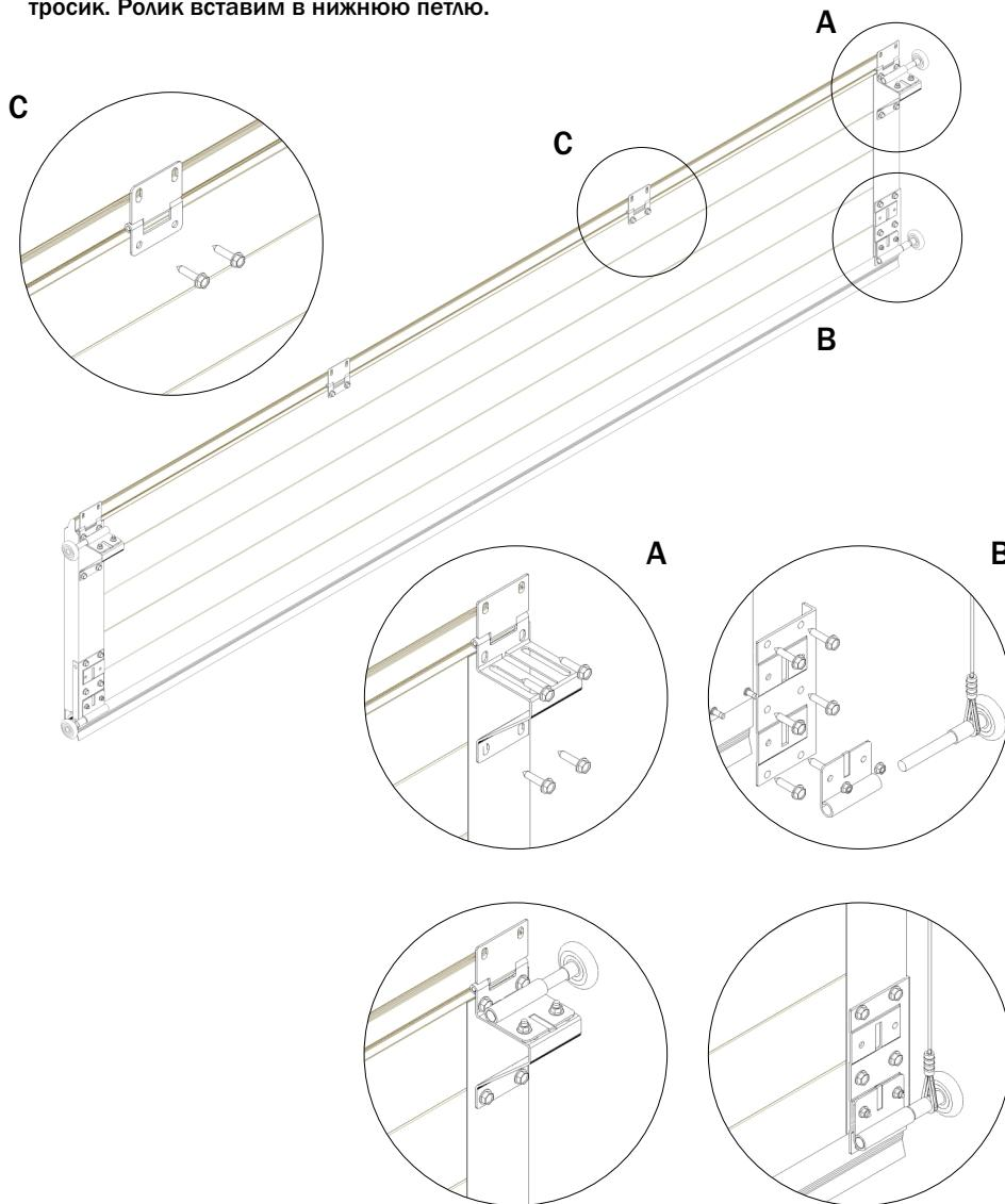
**CZ** Montáž stranových pantů 450CZ+10, středových pantů 450HZ+10, na spodní kolečko navlečeme lanko, kolečko vložíme do spodního pantu.
