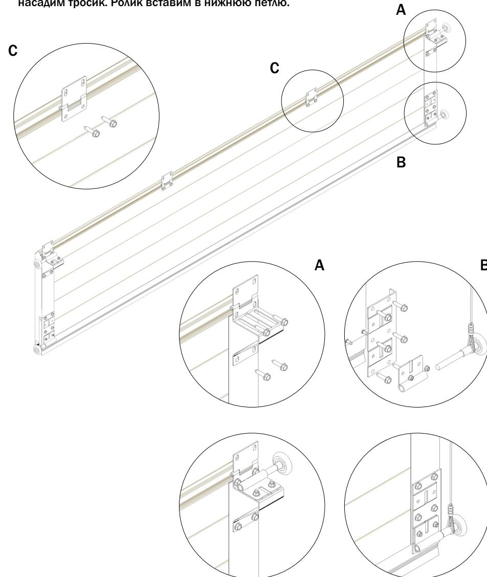
**CZ Montáž svislých kolejnic pomocí C-profilu**
