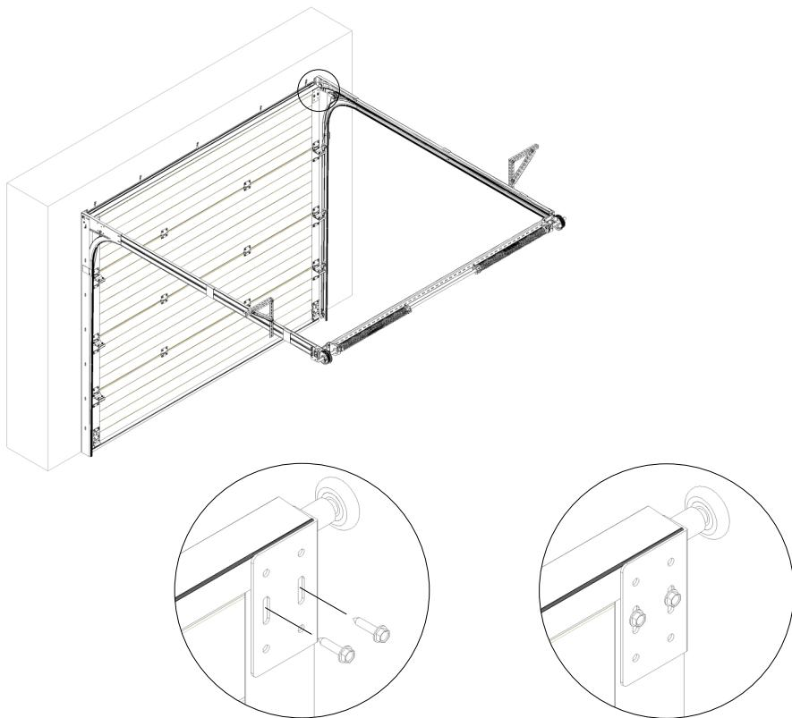
**CZ** Postupně do otvoru skládáme 2, 3 .... a horní sekci. Na horní sekci přišroubujeme horní pant tak, aby horní sekce dostatečně těsnila.
