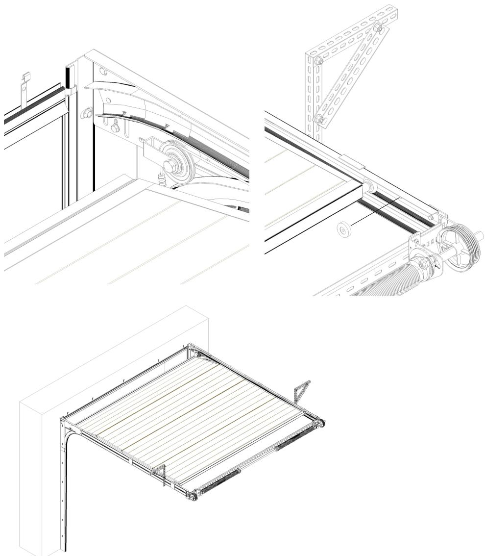
**CZ Návod na demontáž sekčních garážových a průmyslových vrat****Sekční vrata při demontáži musí být vždy v uzavřené poloze!!!****Na vratech neprovádějte demontážní práce dokud neodpružíte torzní pružiny!!!****1) Odpružení torzních pružin**
