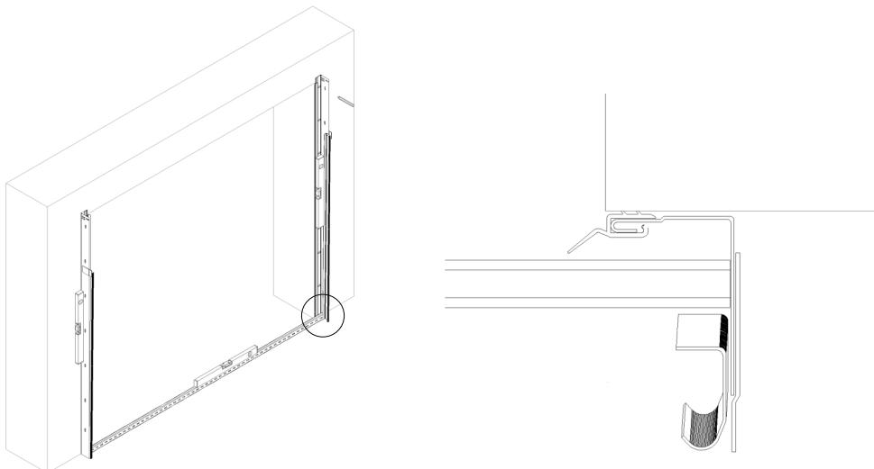
**CZ Montáž svislých kolejnic pomocí spodní sekce**
