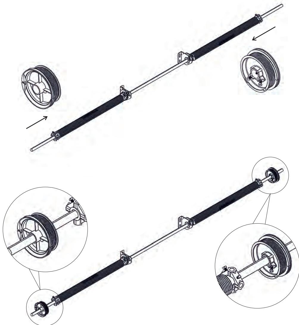
Торсионную систему вставляем в боковую консоль подшипника соединённую с горизонтальной направляющей. Отмечаем места сверления отверстий для крепления предохранителя от разрыва пружин. Просверливаем отверстия диаметром 12 мм под дюбеля. Предохранители от разрыва пружин прикрепляем при помощи болтов к стене.
