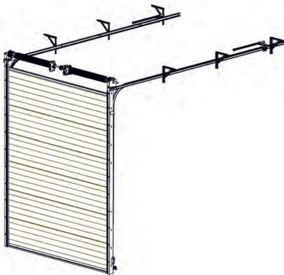
**Система направляющих STD+ для секционных промышленных ворот, с необходимым минимальным надпроёмным пространством (перемычкой) – 420 мм.**
