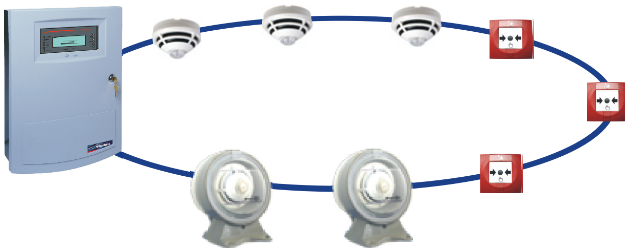
Fig. 26: Vigilon loop wiring
