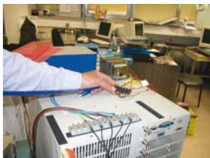
איור 17-5: מגעים חשופים במהלך עבודת הרכבה
