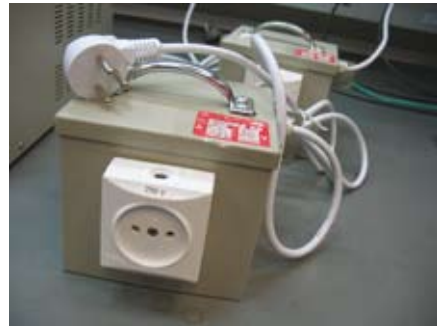
איור 8-3: שנאי-מבדל מיטלטל (דורש בדיקה תקופתית). שימו לב: הזנת יציאה מבית תקע דו-פניי. קיים אישור לבדיקה תקופתית
