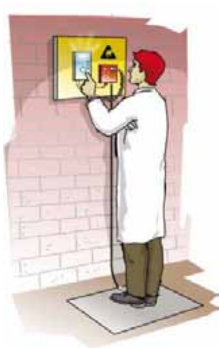
איור 5-6: עמדת בדיקה - לפני העבודה - לתקינות פא"ס דרך גוף העובד
