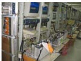
איור 1-11: במיתקני בדיקת ציוד אלקטרוני המגעים לא תמיד מוגנים מנגיעה מקרית
