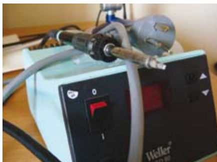
איור 3-7: מלחם עם תקע תלת-פיני - איננו מתאים לדרישות עבור ציוד מסוג "בידוד כפול"
