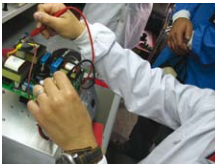
איור 1-4: לפני תחילת עבודה במיתקן חי - יש להסיר מהידיים טבעות, צמידים, שעונים
