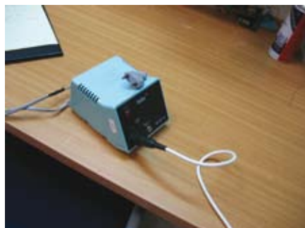
איור 2-7: שנאי למלחם עם תקע דו-פיני המתאים לדרישות עבור ציוד מסוג "בידוד כפול"
