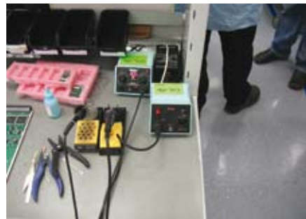
איור 7-1: עמדת הלחמה (Soldering Station) אופיינית מסוג Weller
