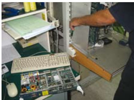
איור 3-2: הארקה הגנה לגוף הציוד ולעמדת העבודה על ידי הארקה ישירה + הארקה אנטיסטטית למעגלים
