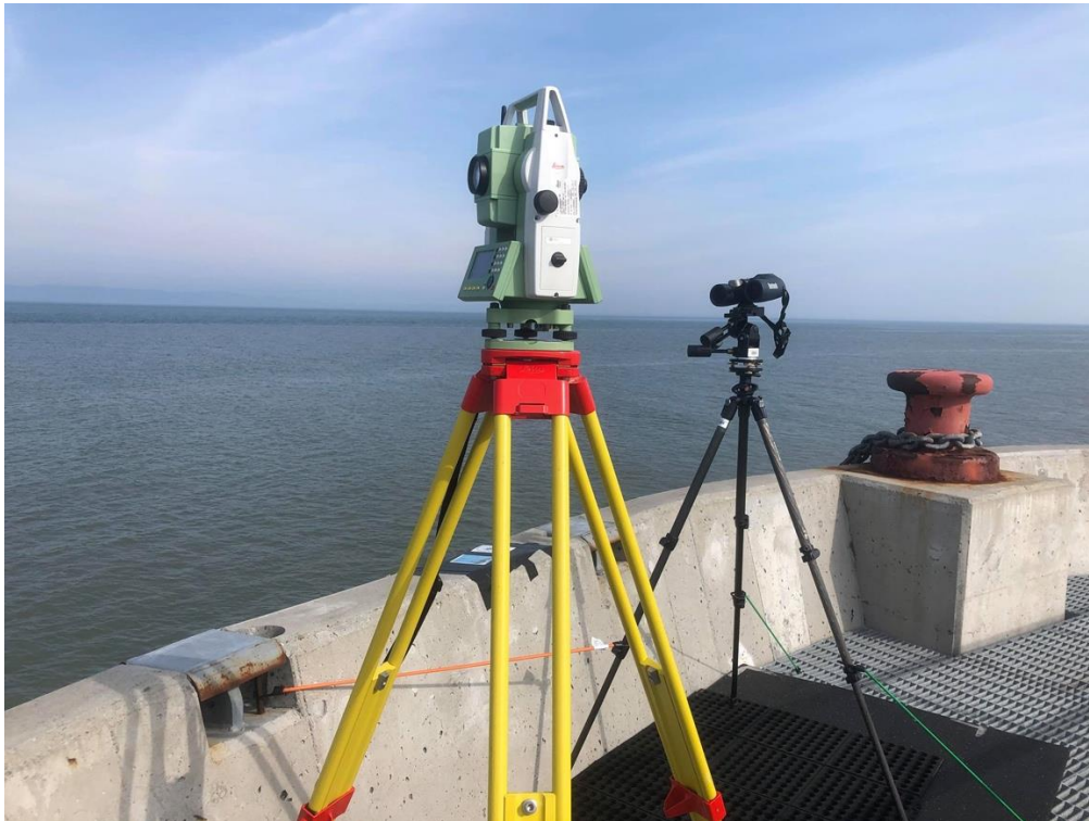
Photo 1. Matériel d'observation (Station totale à gauche et jumelles sur trépied à droite) ; photo prise au bout du quai de Rivière-du-Loup, été 2020.
