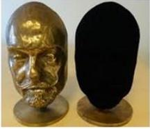
3- مادة فانتيلاك (المادة السوداء): تمكنت شركة بريطانية من صناعة هذه المادة بتقنية النانو، والمادة تتكون من أنابيب نانوية من الكربون التي، يمكنها امتصاص الضوء بنسبة تصل إلى 99.96%، ما يجعلها أكثر المواد ظلمة على سطح الأرض.
