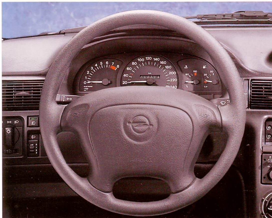
Im Pralltopf des Lenkrades befindet sich der Opel Full Size Airbag.
