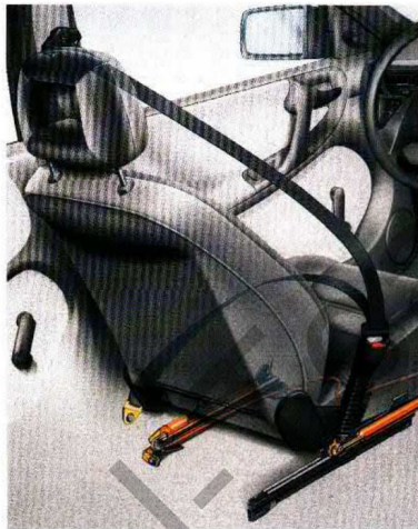
Blitzschnell zieht der Gurtschloßstraffer des Aktivgurt-Systems bei einem Frontalaufprall die Gurte an. Die Vorwärtsbewegung von Fahrer und Beifahrer wird weitgehend reduziert.
