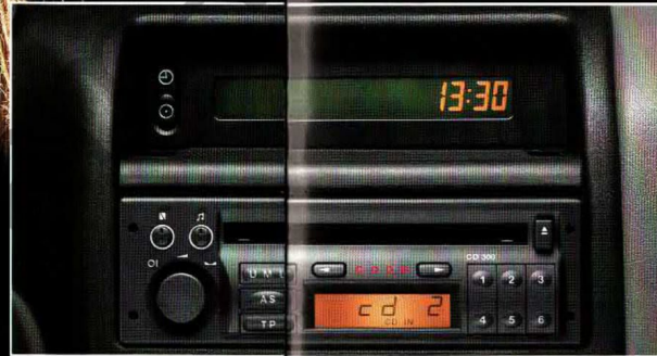
Radio und CD-Player CD 300, 1780313. Modernes Gerät von ausgezeichneter technischer Qualität. Radio mit allen Schikanen: PLL-Synthesizer und Digitalanzeige. Autostore, 24 Stationstasten, elektronischer Senderspeicher, Code-System. CD-Teil: „Track“ – manuelle Anwahlmöglichkeit vorwärts und rückwärts, schneller Vor- und Rücklauf.
