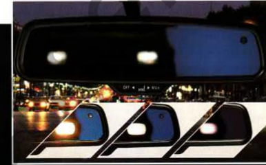
Der automatisch abblendbare Innenspiegel, 17 04 741, ist eine Neuheit: Ein lichtempfindlicher Sensor reagiert, wenn aufblendete Scheinwerfer nahen, und blendet dann automatisch ab. Die Empfindlichkeit des Sensors lässt sich in zwei Stufen regeln.
