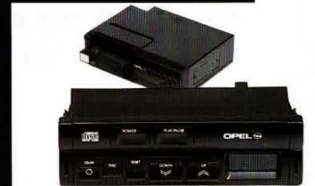
CD-Wechsler: CD-Anlage, bestehend aus CD-Wechsler mit Bedienteil, 1780462, CD-Cassette, 1780464, (ohne Abb.) und Antennen-(FM-)Adapter, 1780463, (ohne Abb.). Der CD-Wechsler hat ein Magazin für bis zu 6 Compact-Discs. Das Bedienteil dient zur Fernbedienung des Wechslers. Der Radio-Anschluß ist mit CD-Cassette oder Antennen-(FM-)Adapter möglich. Die Kombination mit einem zusätzlichen Verstärker ist nicht erforderlich. Optimale Kombination von Klangqualität und Bedienungskomfort. Ausgezeichnete Ausstattung, die ein spezielles Dämpfungssystem durch Anti-Vibrationsfedern, vierfaches Oversampling und automatischen CD-Durchlauf beinhaltet.
