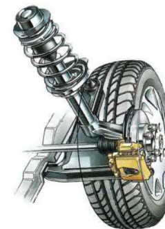
Sicherheitsfahrwerk mit Gasdruck-Stoßdämpfern und -Federbeinen.
