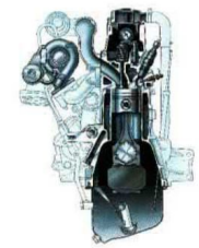
Turbolader bewirken eine bessere Verbrennung und tragen so auch zur Abgasreduzierung bei.
