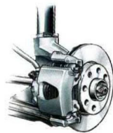
Diagonales Zweikreisbremsystem mit Bremskraftverstärker und Bremskraftregler. Scheibenbremsen vorn, selbstnachstellende Trommelbremsen hinten.
