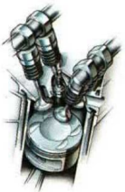
Optimierte Verbrennung: Gemischaufbereitung durch vier Ventile. Kurze Flammwege und effektivere Verbrennung durch zentral platzierte Zündkerze.
