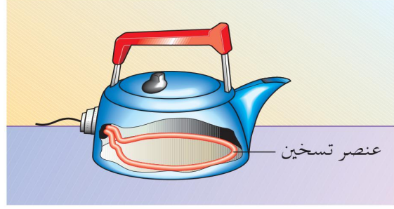
شكل 3-6 ملف تسخين في غلاية كهربائية
