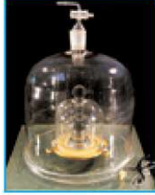
(ب) النموذج الدولي لكتلة الكيلوجرام المعيارية شكل 3-1 كتلة واحد كيلوجرام معيارية وأول نموذج لها
