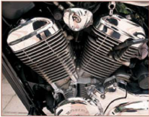
شكل 3-15 محرك دراجة بخارية ذو بنية متعددة الريش لتكبير سطح الإشعاع الحراري
