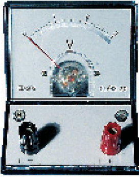
شكل 2-12 يقيس الفولتметр القوة الدافعة الكهربائية أو فرق الجهد
