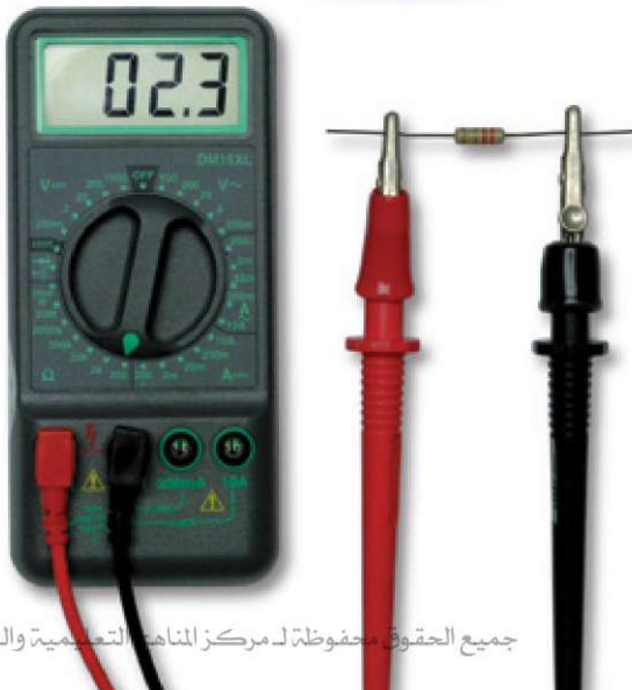
شكل 2-17 قياس المقاومة باستخدام أوميتر
