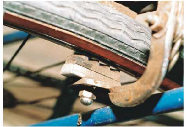
شكل 3 - 23 يسبب الاحتكاك تآكلًا للأجزاء المتحركة في الآلات
