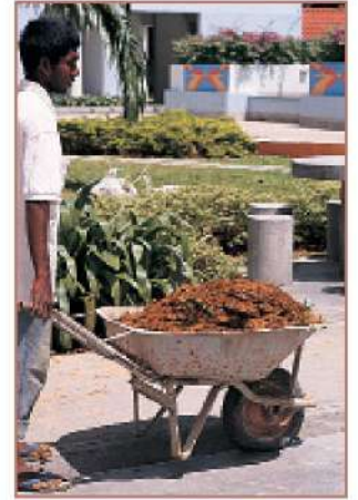
شكل 5-7 أجهزة روافع من النوع الثاني تستخدم يوميًا
