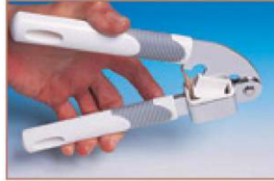
شكل 5-7 أجهزة روافع من النوع الثاني تستخدم يوميًا
