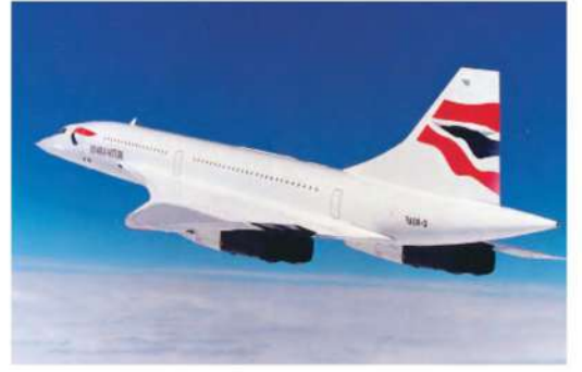
شكل 4-7 طائرة كونكورد - كان يصنع هيكلها من سبيكة ألومنيوم خفيفة الوزن ولكن متينة.
