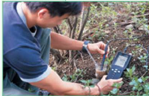
( ب ) يستخدم عداد pH لقياس حمضية وقلوية التربة
