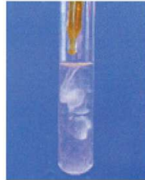
شكل 6-6 التفاعل الذي يحدث عند إضافة ماء البروم إلى محلول الفينول المائي.
