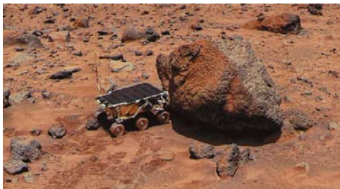
Рис. 5.20. Марсоход Sojourner определяет химический состав марсианского камня при помощи альфа-спектрометра. Фото сделано с посадочной платформы PathFinder.
