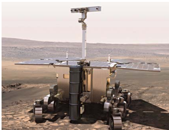
Рис. 5.32. Марсоход по проекту ExoMars (ESA/Роскосмос), предназначенный для биохимического исследования подповерхностного грунта.
