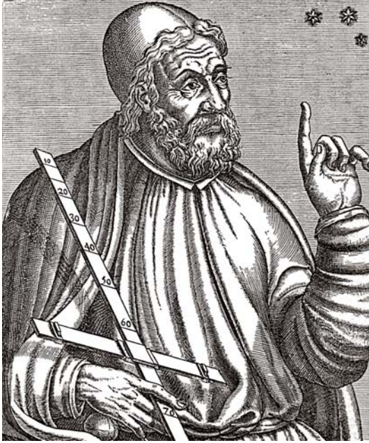
Рис. 1.36. Клавдий Птолемей (II век н. э.) с астрономическим посохом в руке. Условный портрет из книги XVI в. Астрономический посох ( radius astronomicus ), или «посох Якова», — простейший прибор для измерения угловых расстояний на небесной сфере. По основной градуированной линейке скользит подвижная линейка с диоптрами на концах. Глядя от основания главной линейки, малую перемещают так, чтобы диоптры совпали с объектами измерения, например двумя звездами или горизонтом и светилом.
