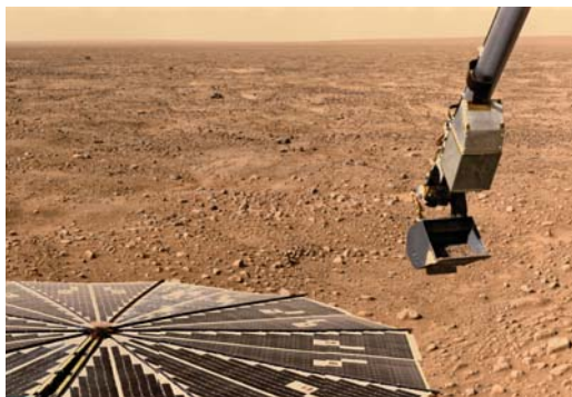
Рис. 5.18. Панель солнечной батареи и ковш «экскаватора» зонда Phoenix, расположенный на роботизированной руке-манипуляторе аппарата. Источник: NASA/JPL-Caltech/University of Arizona/Texas A&M University.
