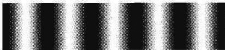
Рис. 2.6. Тень, отбрасываемая перегородкой с двумя прямыми параллельными щелями
